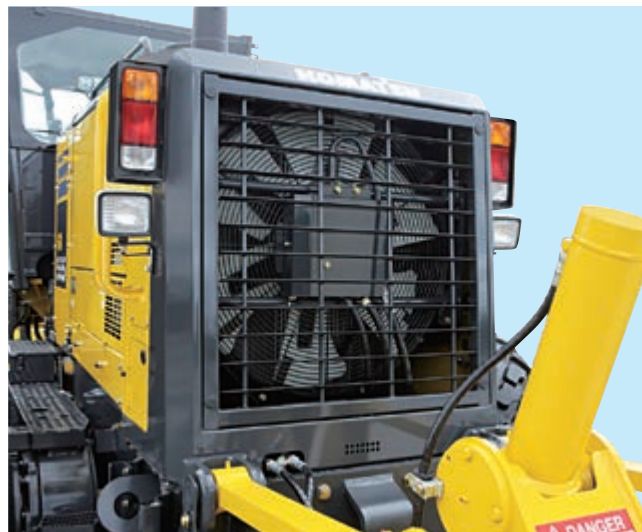
Ventoinha de arrefecimento com transmissão hidráulica
