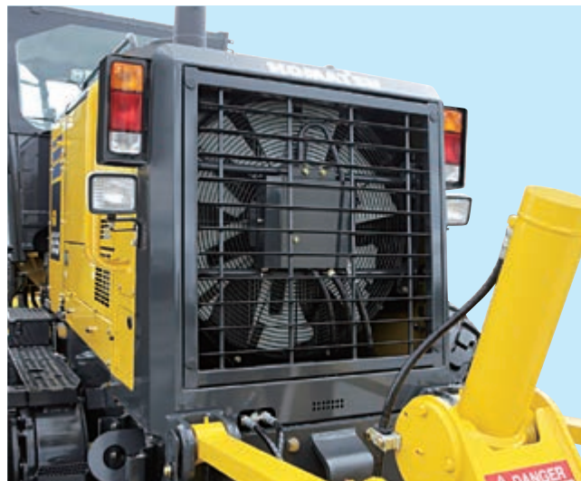
Ventoinha de arrefecimento com transmissão hidráulica
