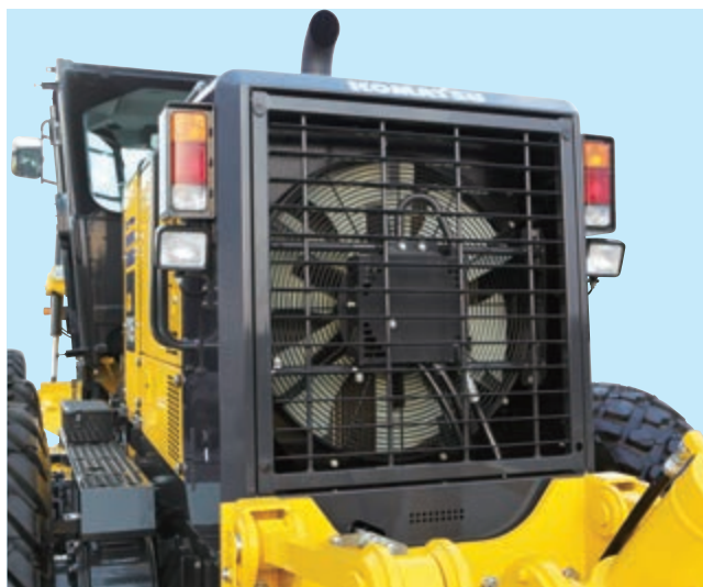
Ventoinha de arrefecimento com transmissão hidráulica
