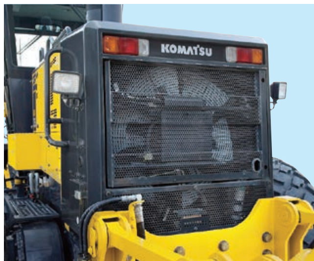
Ventoinha de arrefecimento com transmissão hidráulica
