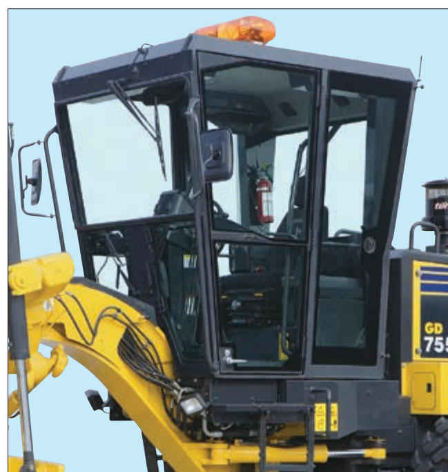
Cabina ROPS (ISO 3471) (Equipada com desembaciador e limpa para-brisas com função intermitente)
