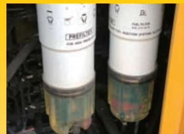
Pré-filtre à carburant grande capacité avec séparateur d'eau
