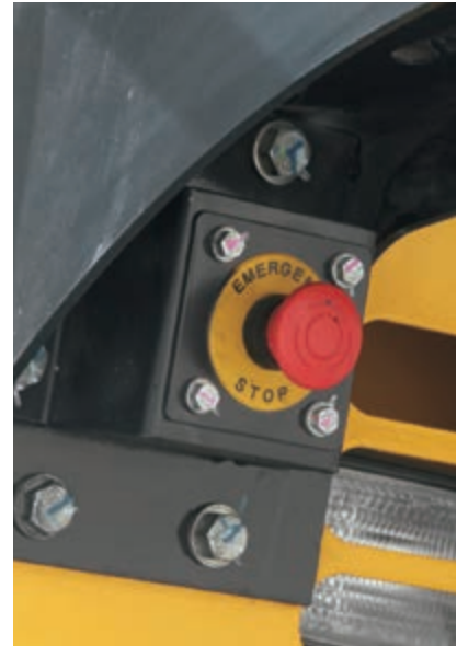
Trois commutateurs d'arrêt d'urgence du moteur sont placés dans la cabine et autour de la machine
