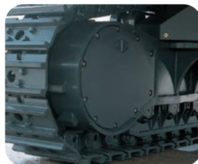
Protections robustes des moteurs de déplacement et protecteurs de rocs
