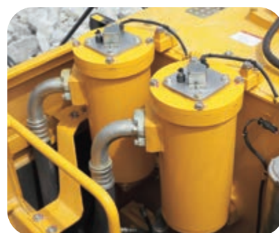
Indicateur de colmatage dans le filtre de vidange hydraulique évitant les dommages du système hydraulique
