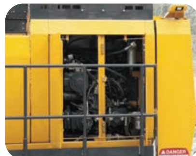
Une cloison évite les projections d'huile sur le compartiment moteur en cas de fuite d'huile
