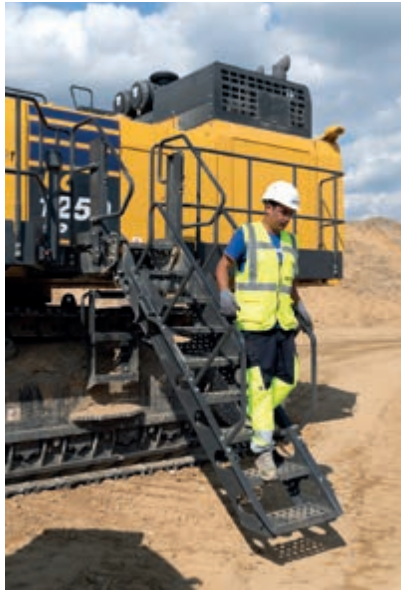
L'escalier hydraulique permet un accès et une sortie plus sûrs de la machine.
