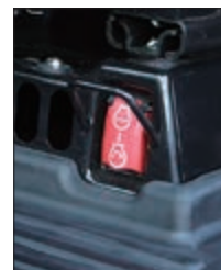
Interrupteur d'arrêt secondaire du moteur et avertissement de ceinture de sécurité
