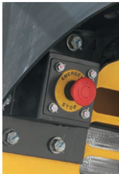
Três interruptores de paragem de emergência do motor estão instalados na cabina e em redor da máquina.
