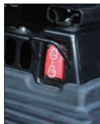
Interruptor de paragem de emergência do motor e aviso de cinto de segurança
