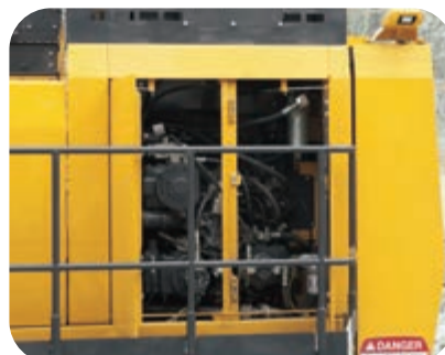
A parede de antepara (parede corta-fogo) impede que o óleo salpique para o compartimento do motor em caso de fuga de óleo hidráulico
