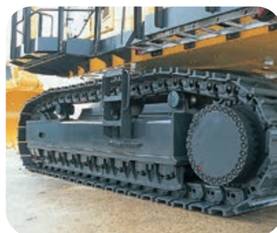
Proteção dos roletes a todo o comprimento
