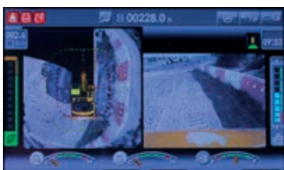
Com o sistema KomVision, é possível observar as várias câmaras disponíveis ou manter a visualização "birdview"
