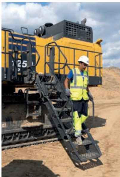
Os degraus hidráulicamente operados permitem o acesso seguro e a saída de e para a máquina.
