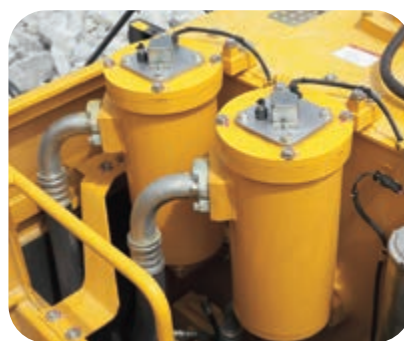
O detetor de obstrução no filtro de retorno hidráulico evita danos no sistema hidráulico
