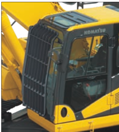
Proteção frontal a toda a altura da cabina de nível 2 (ISO 10262)
