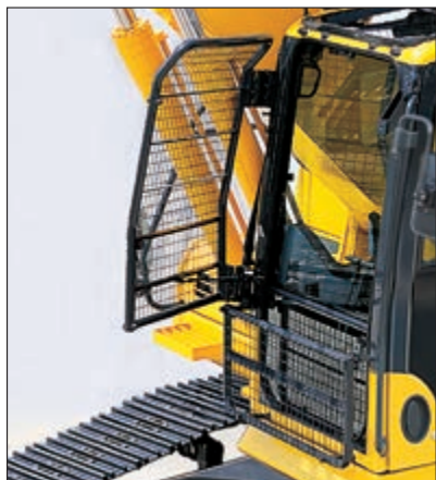
Proteção frontal a toda a altura da cabina de nível 1 (ISO 10262)
