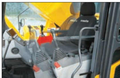
Gama de deslizamento do assento: 340 mm
