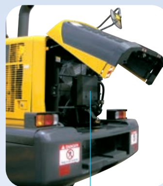
Ventilateur à entraînement hydraulique
