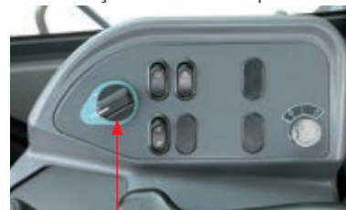
Interruptor de seleção do modo de mudança de engrenagem
