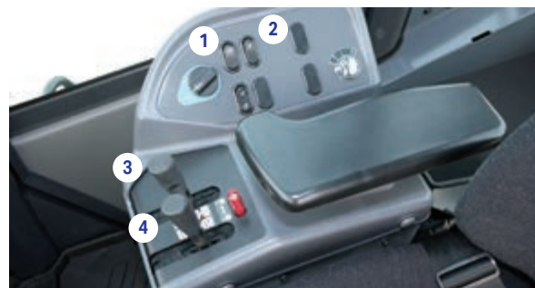
1: Interruptor LIGAR/DESLIGAR de corte 2: Interruptor do ajuste de corte 3: Controlo da lança 4: Controlo do balde
